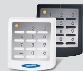
Funk-Codetaster Signal 218 10 Codes, 433 MHz, KeeLoq-Wechselcode mit Edelstahlblende, hinterleuchtet, aus UV-beständigem Material, wahlweise in weiß oder schwarz
