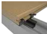
Art.-Nr. 9365/9467 Montageclip für CHARACTER MASSIVE und MAJESTIC MASSIVE PRO passend für alle Alu- Trägerprofile, drehbar, muss immer verschraubt werden
